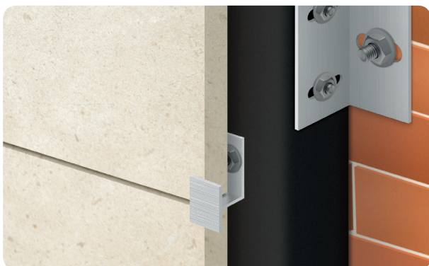
Befestigung mit sichtbaren Klammern
